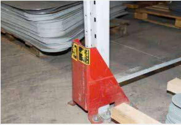
Şekil A.6.11: Kolon muhafazası örneği
